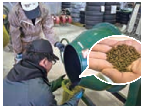
▲鉄粉を塗した種子が、噴霧、乾燥を経て酸化した状態になります
